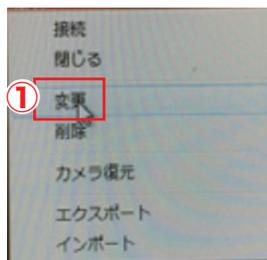
①ソフト起動後、パスワードを変更するNVR名の上で右クリックし、「変更」を選択します。
